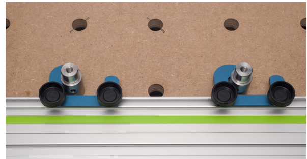
Bewegung längs zur Führungsschiene in eine Richtung und quer zur Führungsschiene gesperrt.
