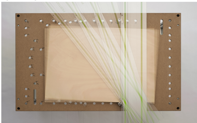
Abbildung 4: Verschwenken von Führungsschiene UND Werkstück bei der Vario-Bench
